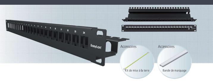
Le panneau de distribution 19" 1U peut être chargé avec jusqu'à 24 modules preLink® / fixLink® RJ45 Keystone. Le panneau comporte deux niveaux. Cela positionne les modules à fleur avec le panneau frontal. Le panneau de distribution peut être commandé en acier inoxydable ou feuille d'acier à revêtement par poudre.
