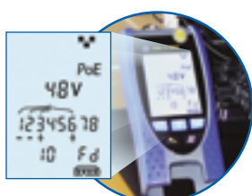
Détection de service
