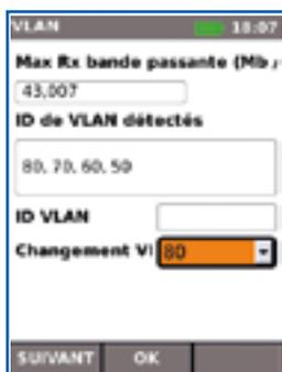
La détection automatique des identifiants VLAN permet à l'utilisateur de configurer NaviTEK NT pour une utilisation sur un VLAN choisi.
