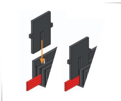
Clapet de verrouillage holder en place
