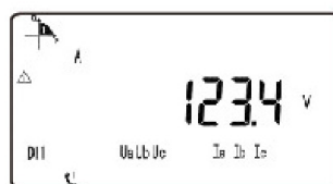
Tension en phase A
